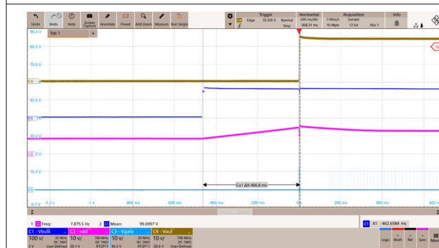
图 8-6. 115Vac 和空载条件下的启动波形
