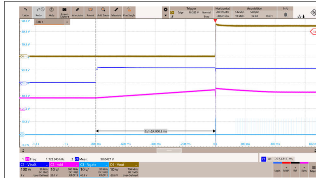
图 8-4. 85Vac 和空载条件下的启动波形
